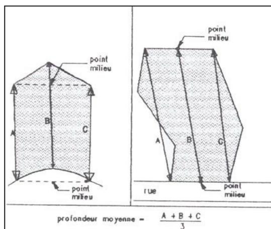
**Figure 2.7: Profondeur moyenne d'un lot irrégulier**
