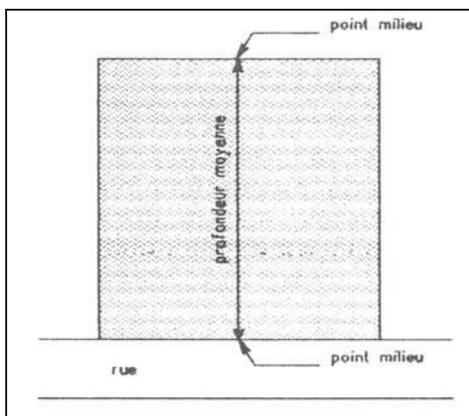
**Figure 2.6: Profondeur moyenne d'un lot**
