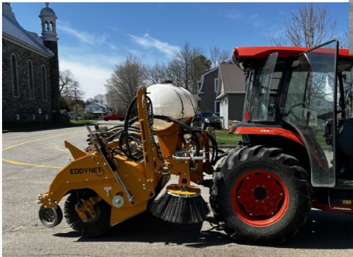
Balais EddyNET RTH24-06 (ramasseur)
