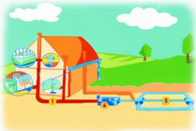
Figure 1. Cheminement des eaux usées.
