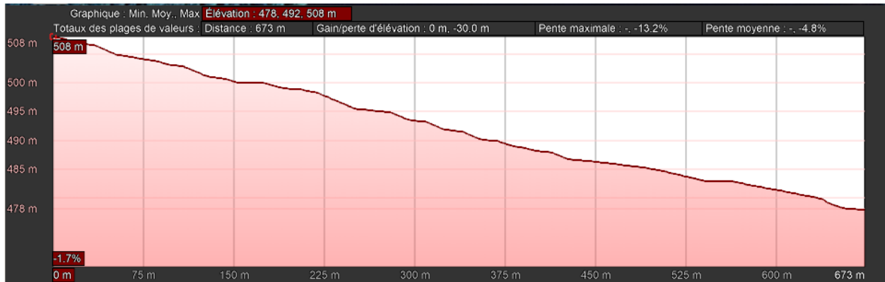
Figure 4: Profil de dénivellation du fossé sur la longueur entre la route 263 et le lac Trois-Milles
