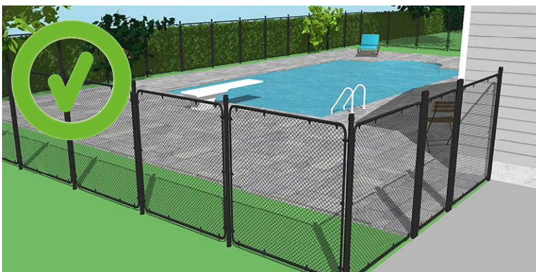
Exemple de clôture en mailles de chaîne dont la largeur est de moins de 30 mm.
