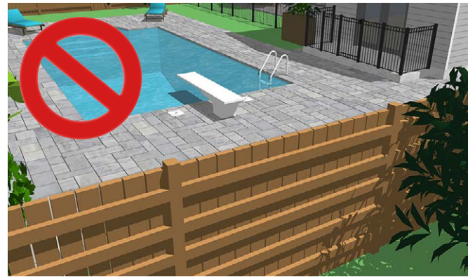
Les travers horizontaux sont trop rapprochés et pourraient permettre à un enfant d'escalader la clôture.
